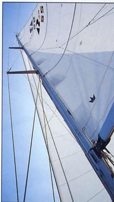
Si tratta di un piano a 9/10 senza sartie volanti e crocette inclinate verso poppa. L'estruso è di dimensioni adeguate e la superficie sufficiente ad ottenere buone prestazioni.
